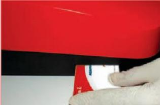
Inserte la tarjeta inteligente con datos de calibración específicos del lote para programar el analizador según las instrucciones de la pantalla
